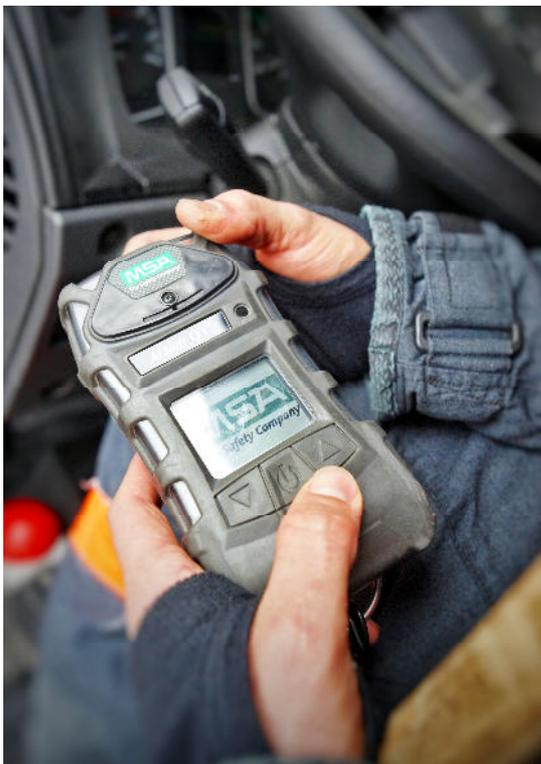
**Messgerät MSA Altair 5X ermöglicht das Messen von 5 Gasen**
