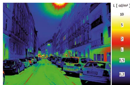
Abb. 27: nach der Umrüstung auf eine gezielte LED-Beleuchtung
