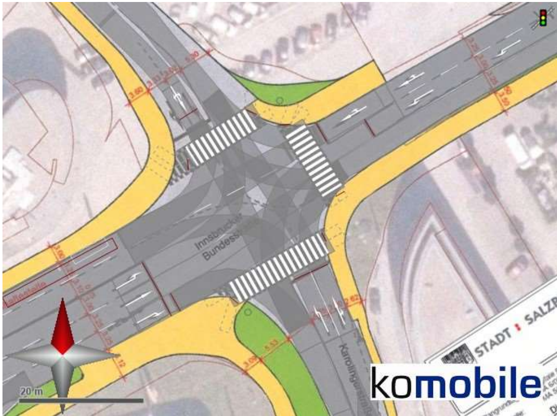
Abbildung 7-8: Geometrie/Fahrfstreifenaufteilung am Knoten B1/Michael-Walz-Gasse in den Varianten 1a/1b
