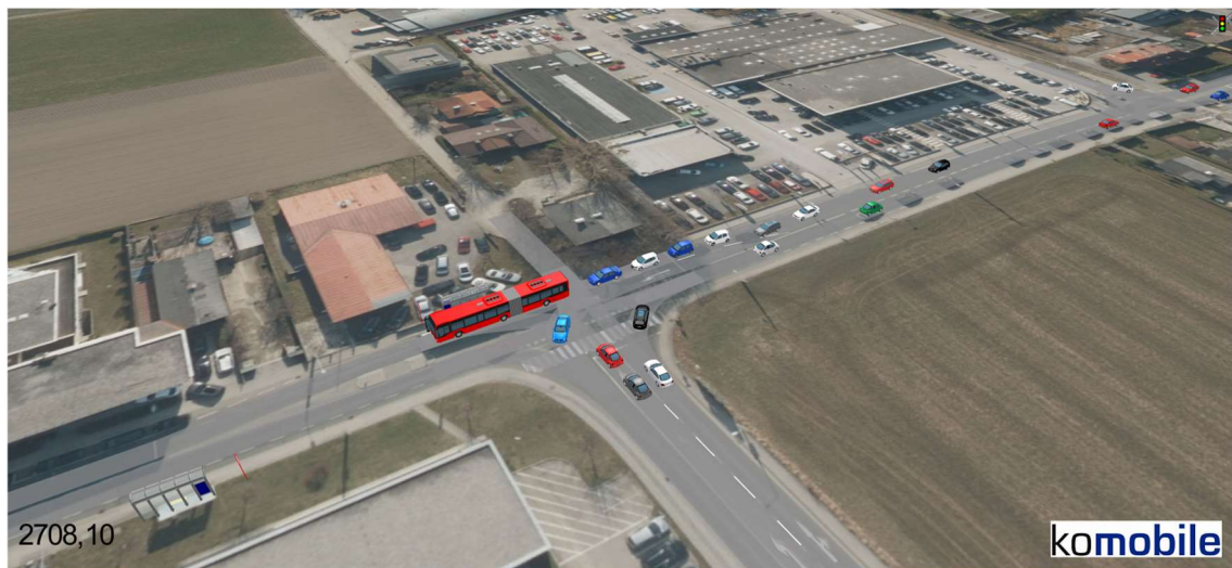
Abbildung 3-19: Auszug Simulationsablauf – B1/Michael-Walz-Gasse – nicht signalisiert mit zwei Fahrstreifen in der nördlichen Zufahrt M.W.G. (Bestand und Variante 2)
