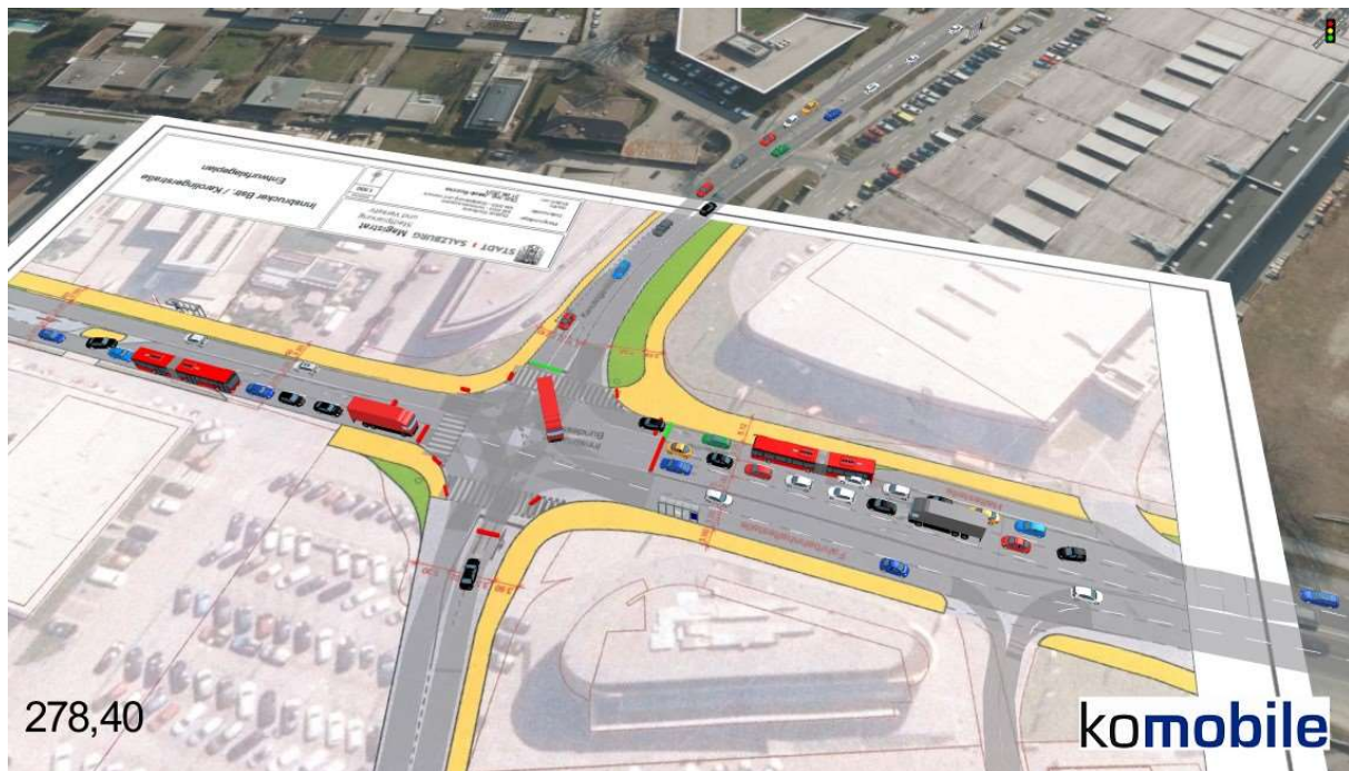
Abbildung 3-19: Auszug Simulationsablauf – B1/Michael-Walz-Gasse – nicht signalisiert mit zwei Fahrstreifen in der nördlichen Zufahrt M.W.G. (Bestand und Variante 2)
