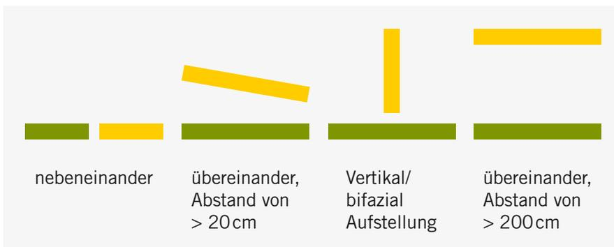
Abbildung 4: Kombinationsmöglichkeiten von Solartechnologie und Dachbegrünung @ GRÜNSTATTGRAU und Stadt Salzburg
